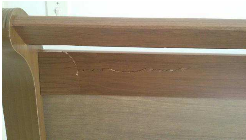
Figura 2 - Defeito ocasionado pelo excesso de força na hora da colocação do parafuso
