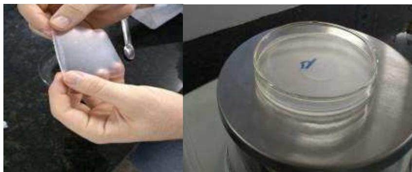
Figura 6: Bioplástico produzido em laboratório a partir do amido de milho
