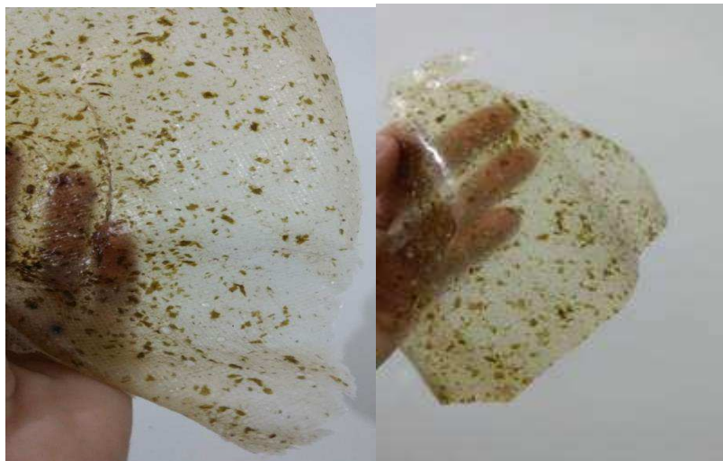
Figura 9: Textura do bioplástico de amido de milho com fibra da casca da manga no TNT e na forma de vidro, respectivamente
