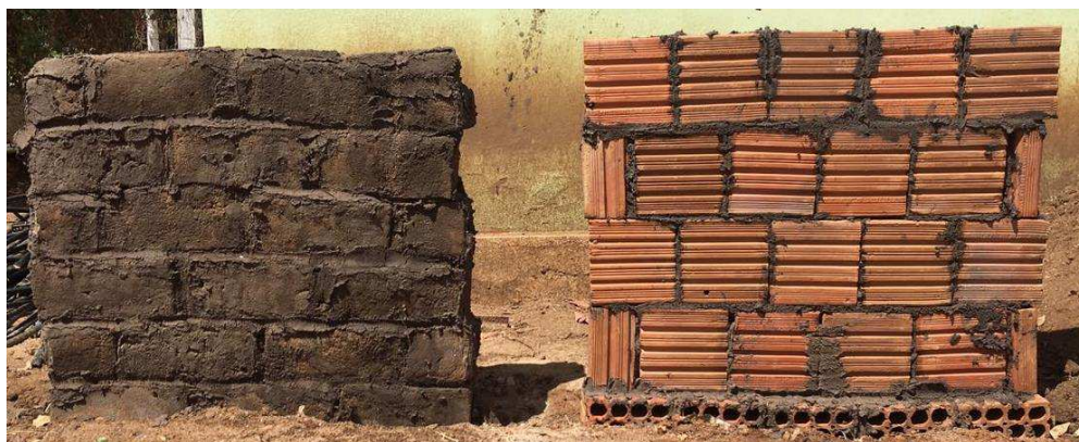
Figura 3 – Parede de tijolo de terra crua à esquerda na foto e parede de tijolo tradicional de 8 furos à direita na foto
