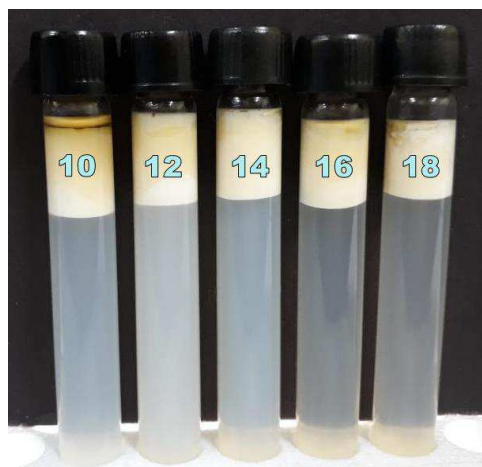
Figura 12 - Emulsões obtidas a partir do éster vanílico, com seus respectivos valores de EHL
