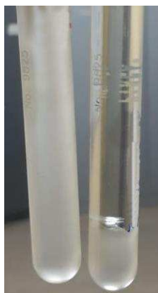
Figura 14 – Formulações de EHL 12 empregando óleo de soja (a esquerda) e éster vanílico (a direita)
