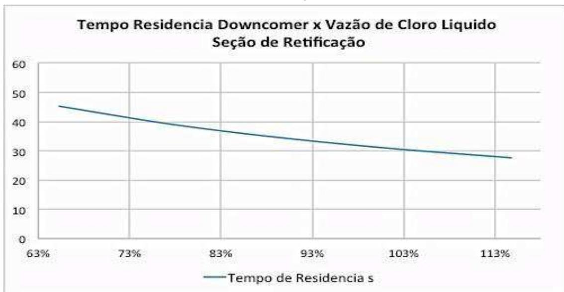
Figura 35: Tempo de residência no downcomer em função da variação da vazão de líquido de alimentação
