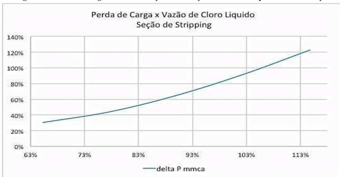
As demais variáveis estão consonantes com as avaliações dos demais parâmetros e as temperaturas na seção de retificação afetam diretamente a seção de stripping devido a geração de maior fluxo descendente na coluna.
