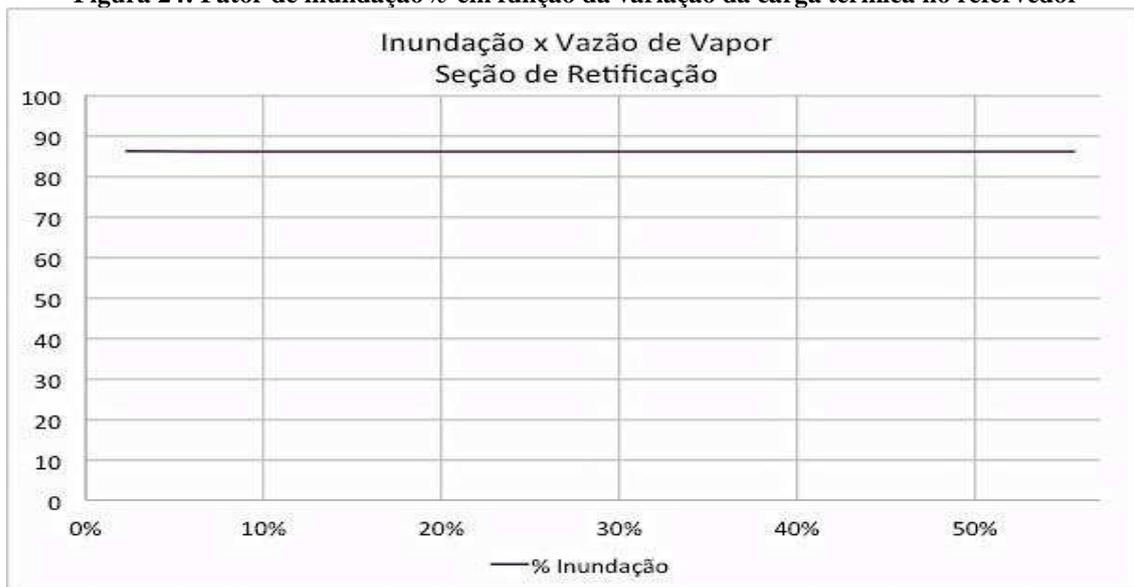
**Figura 25: Fator de inundação % em função da variação da carga térmica no refeedor**
