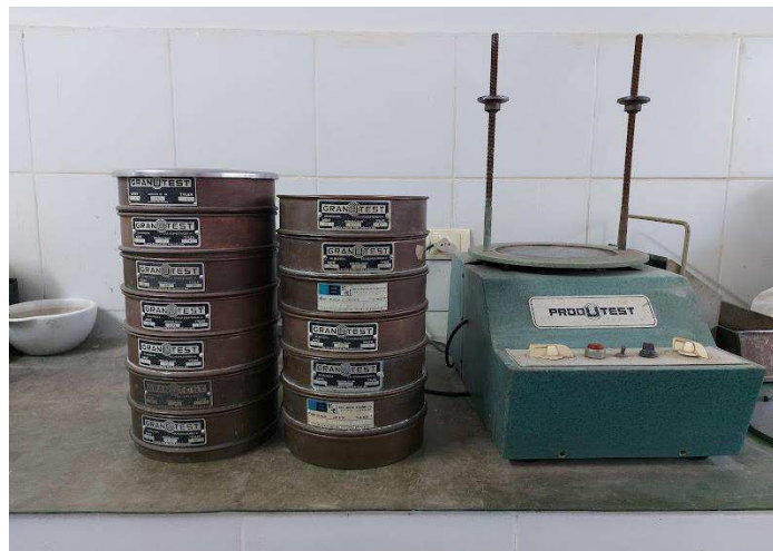
Figura 12– Conjunto de peneiras e o agitador eletromagnético. (Dados da Pesquisa, 2022).
