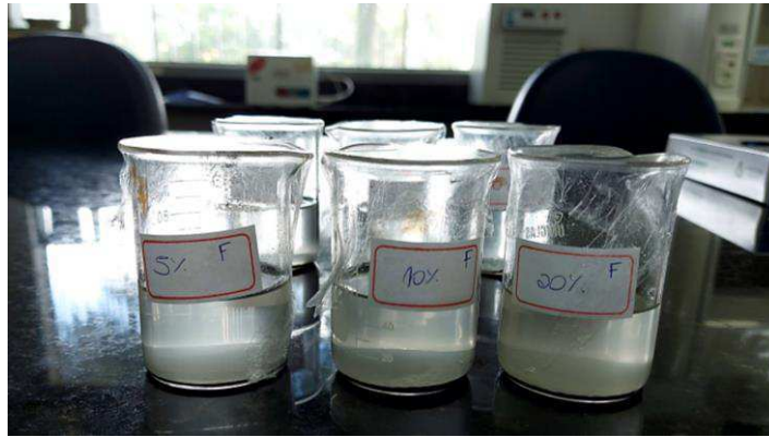
Figura 16 - Amostras solubilizadas em Hidróxido de Sódio (NaOH) em porcentagens de 5%, 10% e 20%. (Dados da Pesquisa, 2023).
