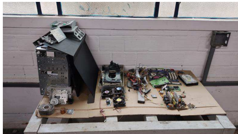
Figura 8 – Gabinete desmontado e seus macros componentes separados. (Dados da Pesquisa, 2022).
