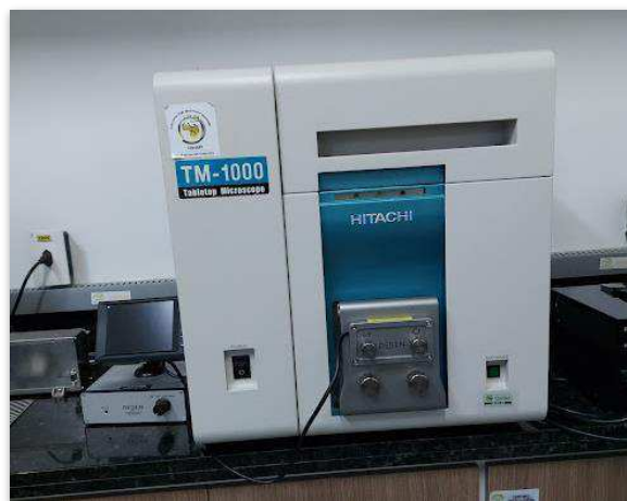
Figura 13 - Equipamento de MEV-EDS modelo TM-1000. (Dados da Pesquisa, 2022).
