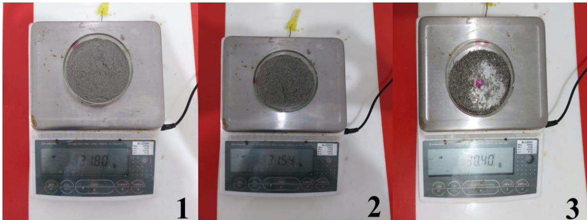
Figura 17 - Amostra 1: Material não-magnético com o retido a 325 mesh ; Amostra 2: Mistura do material magnético e não-magnético retido a 100 mesh ; Amostra 3: Material magnético retido na peneira de 325 mesh . (Dados da pesquisa, 2023).
