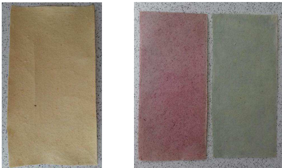
Figura 3 -Papel confeccionado com a fibra da folha da bananeira e acréscimo de materiais, sem coloração do lado esquerdo e com coloração do lado direito
