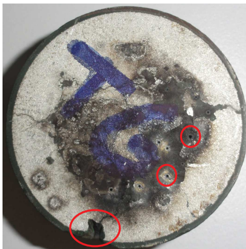
Figura 4.21 – Fotografia de um varistor degradado.
