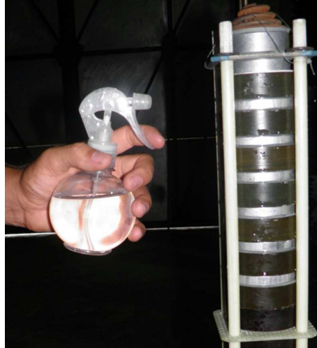
Figura 4.23 – Fotografia mostrando o processo de umidificação de um para-raios.
