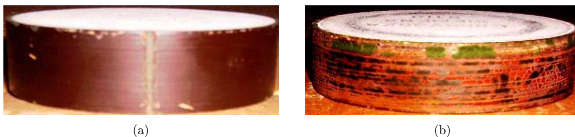
Figura 4.4 – Fotografias de varistores com colar isolante: (a) Carbonizado; e (b) Degradado por reações químicas.
