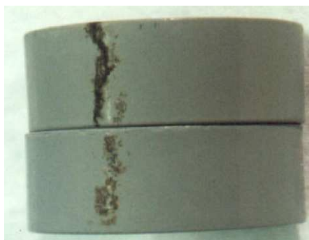
Figura 3.3 – Fotografia de varistores degradados devido à ação de descargas parciais (CHRZAN, 2004).
