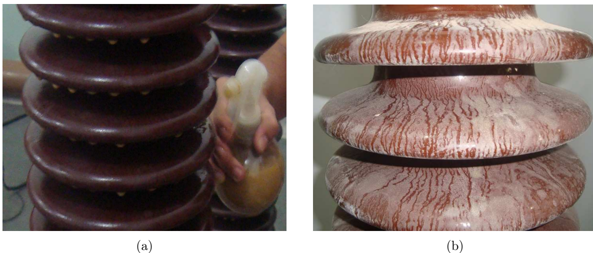
Figura 4.15 – Fotografias: (a) Borrifando poluição no invólucro; e (b) Estado do invólucro após secagem da poluição.
