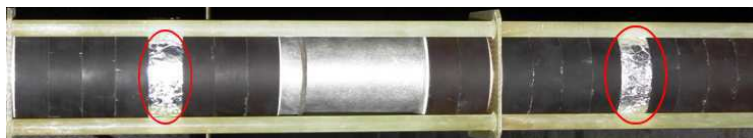
Figura 4.19 – Fotografia de uma coluna de varistores com pastilhas curto-circuitadas.
