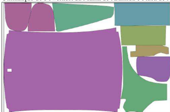
Figura 4 - Otimização do Pownest da Manta de Aramida e Placa de Aço – Placa 1
