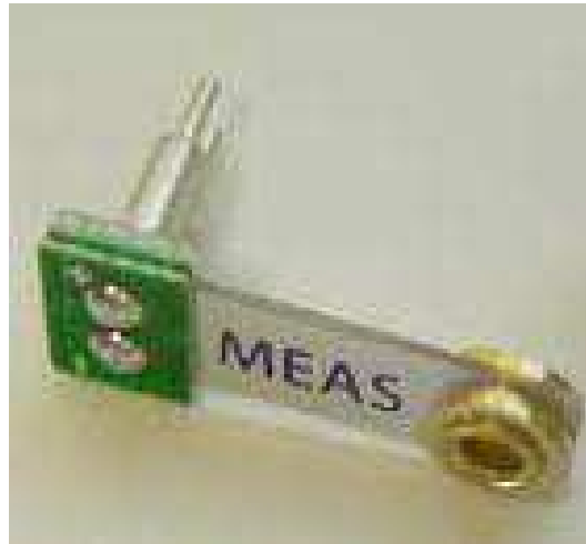
Figura 5.39: Ilustração do gerador piezoelétrico Mini sensor SEN 09198.
