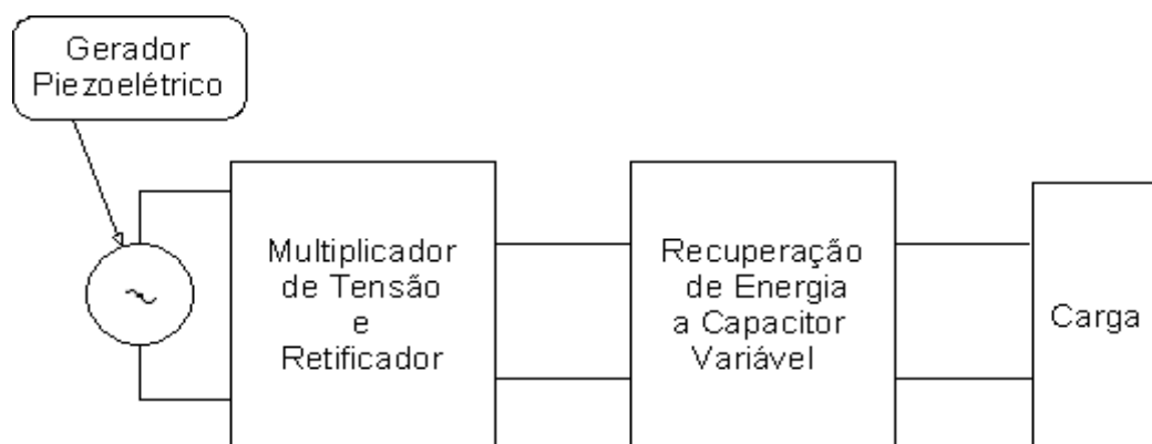
Figura1. 4: Diagrama do sistema de recuperação de energia utilizando gerador piezoelétrico e capacitor variável.
