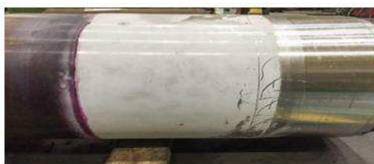
Figura 2 – Faixa do rolo na qual foi realizado o ensaio de líquido penetrante.
