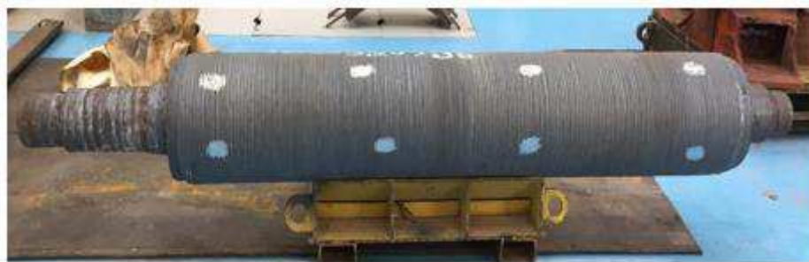
Figura 1 - Rolo de lingotamento contínuo preparado para os ensaios de dureza
