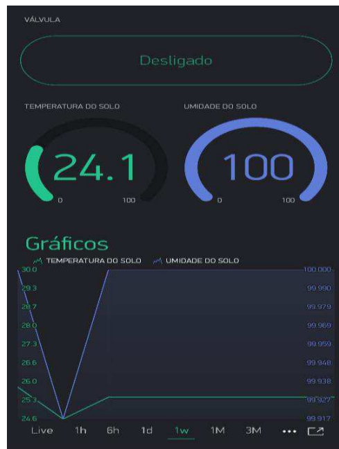
Figura 3 - Dashboards e gráficos gerados a partir dos dados coletados pelos sensores e botão de acionamento.
