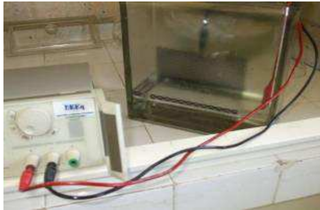
Figura 20 - Montagem experimental para anodização
