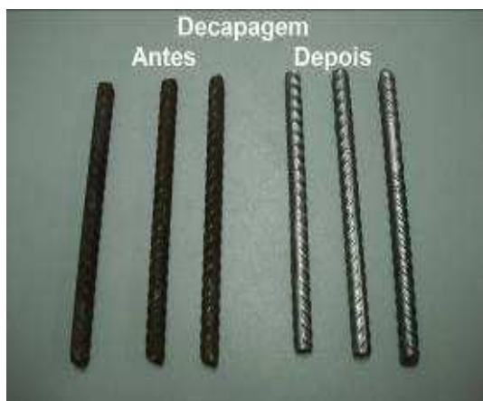
Figura 21 - (a) Limpeza das armaduras
