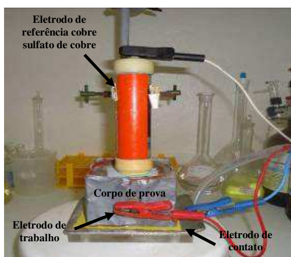
Figura 25 – Montagem experimental para as técnicas de polarização linear e impedância eletroquímica. Temperatura = 26 \pm 1^\circ\text{C} .
