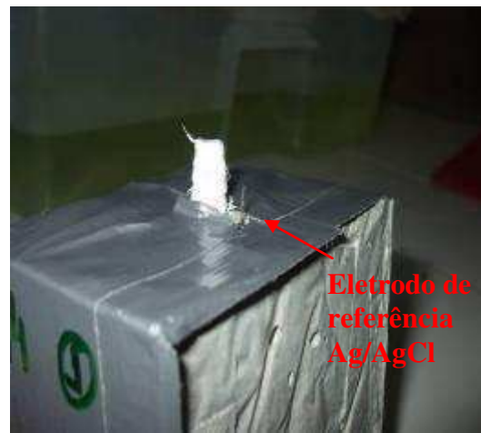
(b) Corpo de prova com sensor Ag/AgCl
