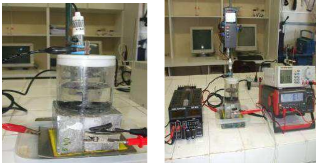
Figura 23 - Representação esquemática de indução da corrosão por íons cloretos em ensaio elétrico
