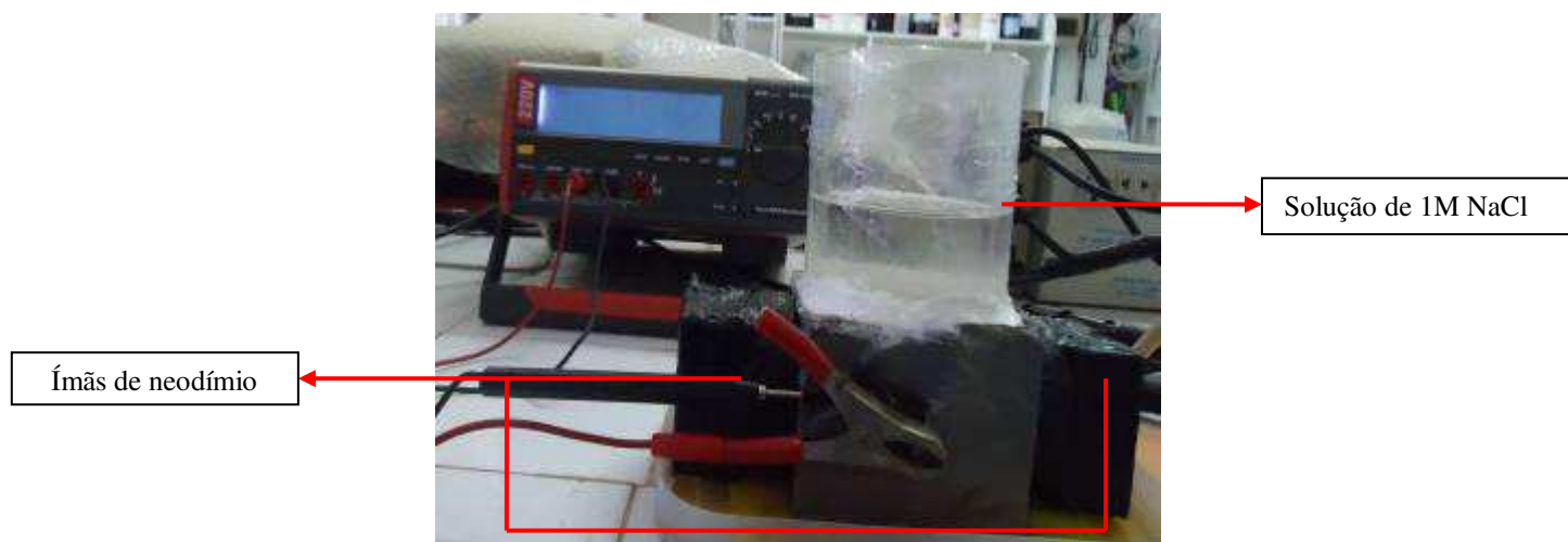
Figura 24 - Representação esquemática de indução da corrosão por íons de cloretos em ensaio magnético
