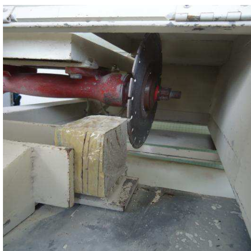
Figura 28- (a) Máquina de corte: fatiamento dos Cps
