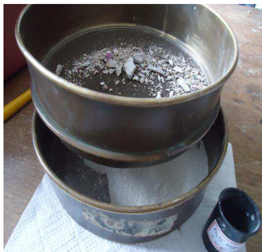
(b) pulverização e peneiração das amostras de concreto. (Arquivo pessoal)
