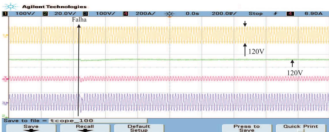
Figura 3.30: Falha ocorrida num sincronismo dentro do intervalo ótimo de tensão de barramento (Na mesma tela são representadas de cima para baixo:  $e_g$ ,  $E$ ,  $i_g$ ,  $v_{23}$ .)
