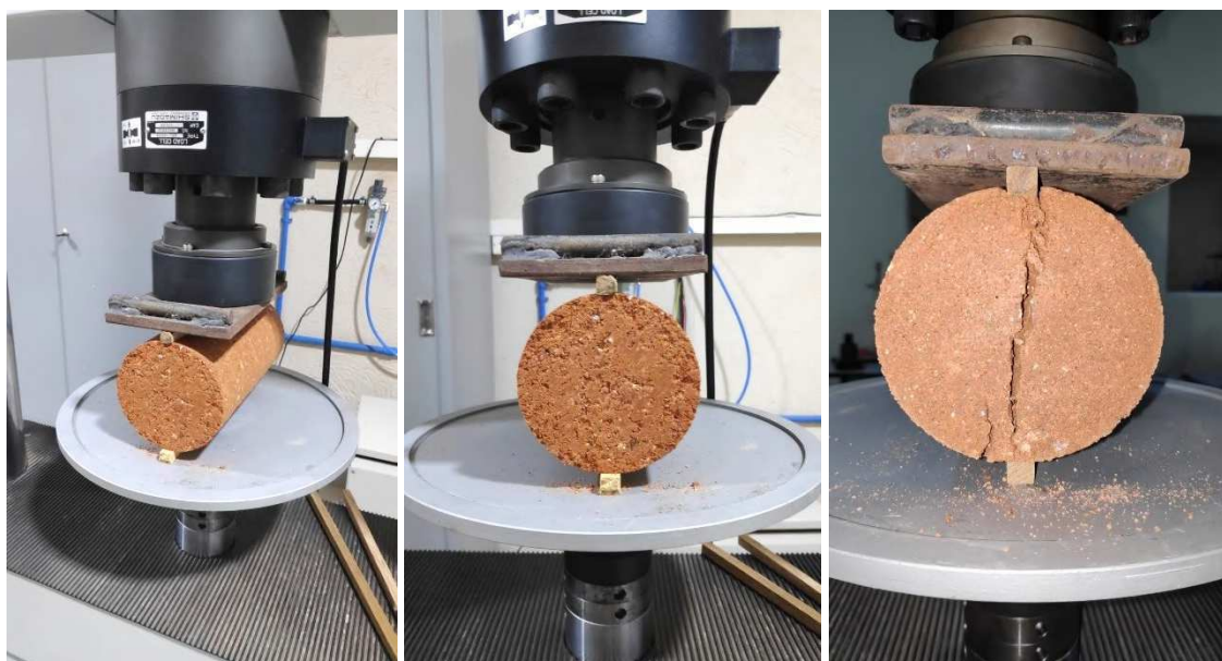
Figura 74: Resistência à tração por compressão diametral com deformação controlada
