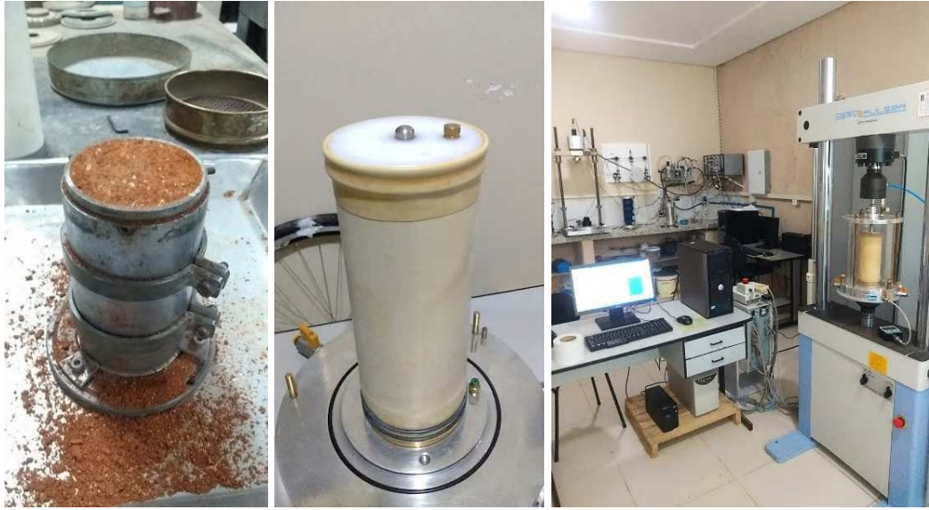
Figura 76: Ensaio de deformação permanente
