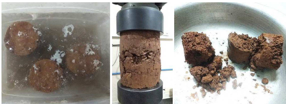
Figura 169: RCS do SLP (PB-3) com 1% de cimento
