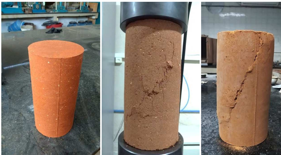
Figura 73: Resistência à compressão simples com deformação controlada
