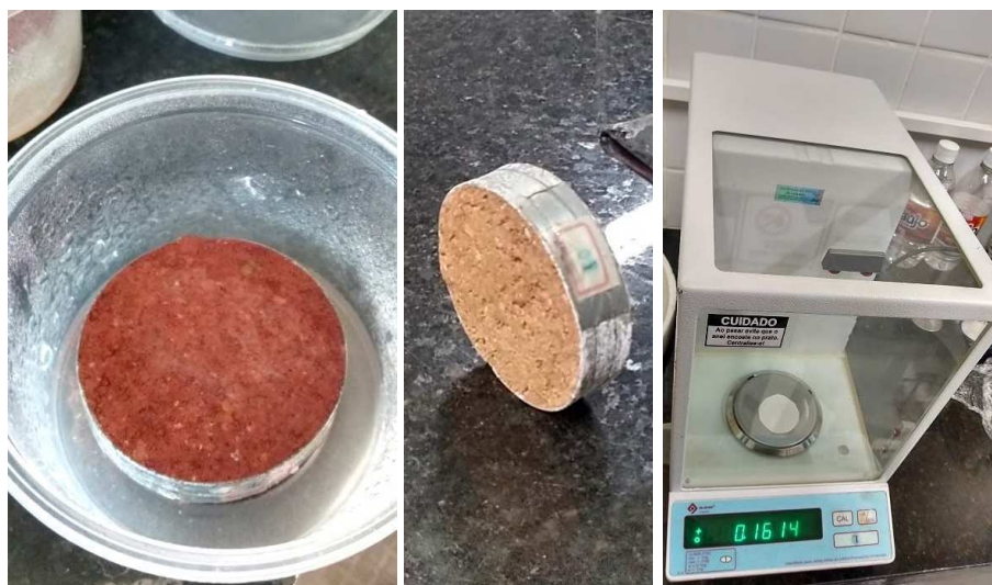
Figura 80: Processo de saturação e secagem dos corpos de prova e pesagem do papel filtro
