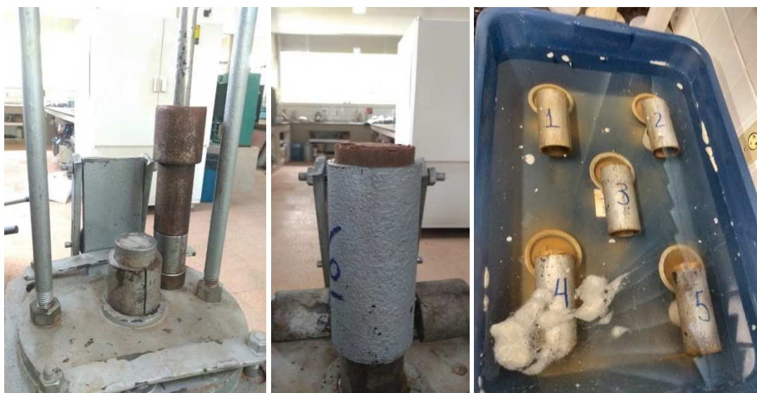
Figura 55: Ensaio para classificação MCT e G-MCT
