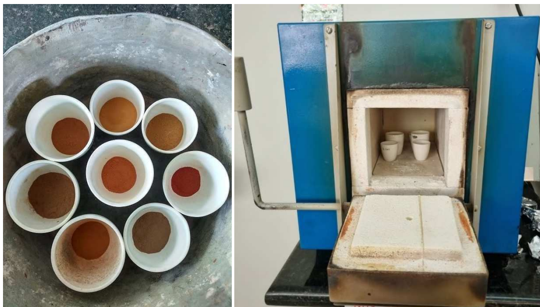
Figura 40: Mufra para calcinação dos materiais
