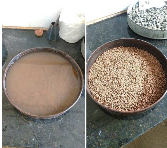
Figura 50: Execução do ensaio de degradabilidade
