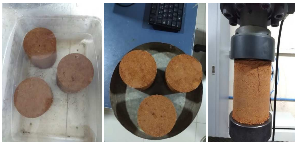
Figura 70: Dosagem do teor de cimento
