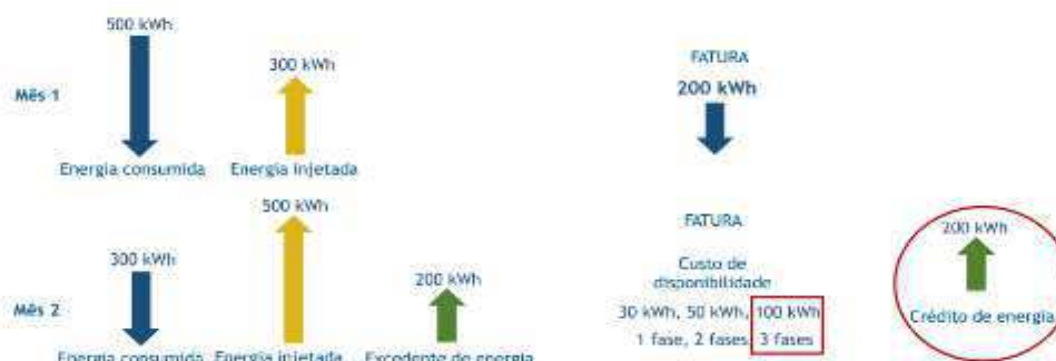
Figura 8 – Sistema de compensação de energia elétrica.
