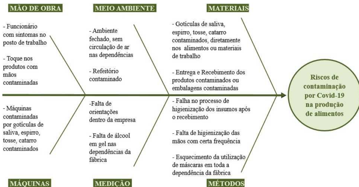
Figura 4 – Diagrama de Ishikawa dos riscos da contaminação por COVID-19 na produção de alimentos
