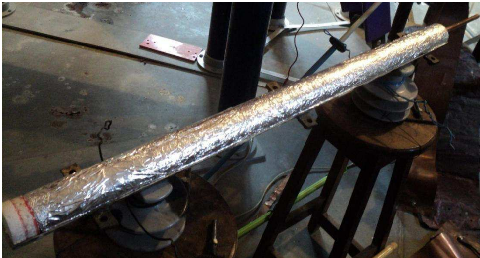
Figura 14. Fotografia de uma das hastes concretadas no interior do molde metálico.
