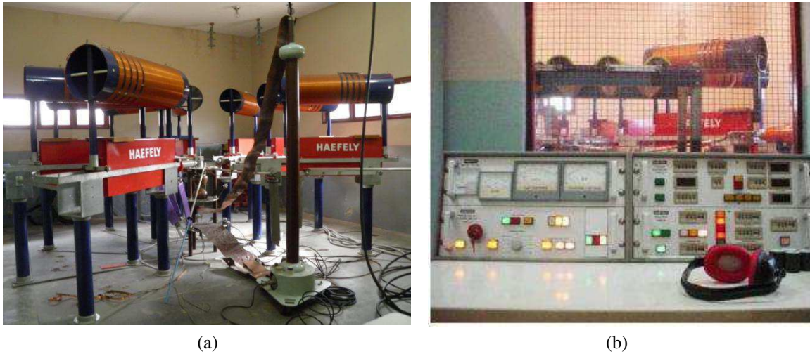
Figura 8. (a) Fotografia do gerador de impulsos de corrente; (b) mesa de controle do gerador.
