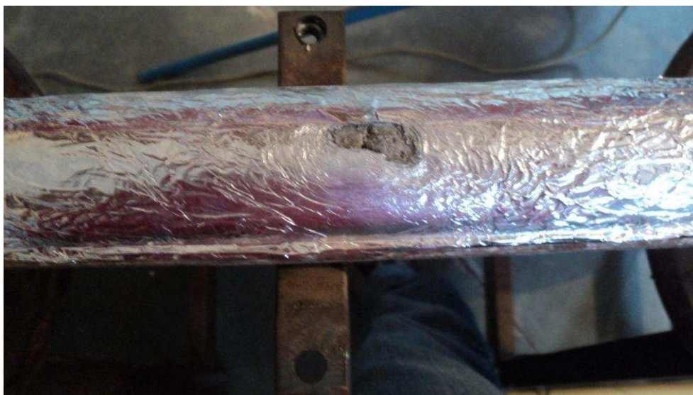
Figura 16. Fotografia de ruptura na estrutura de concreto em uma das hastes concretadas.
