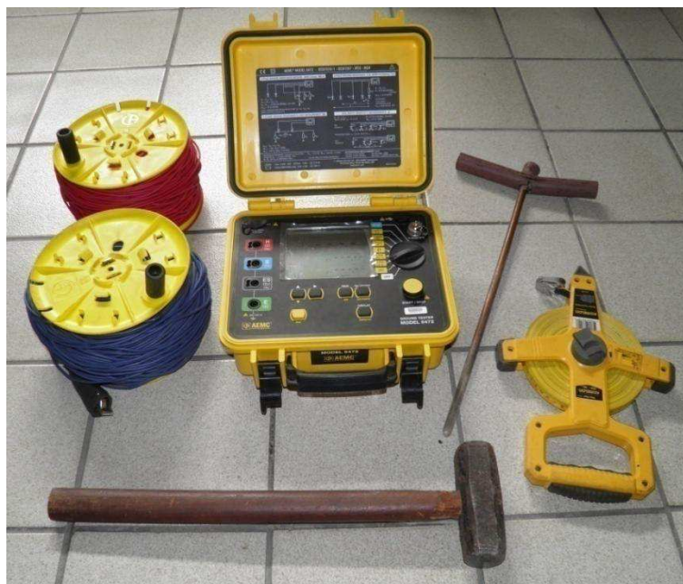
Figura 5. Fotografia do terrômetro e seus acessórios.
