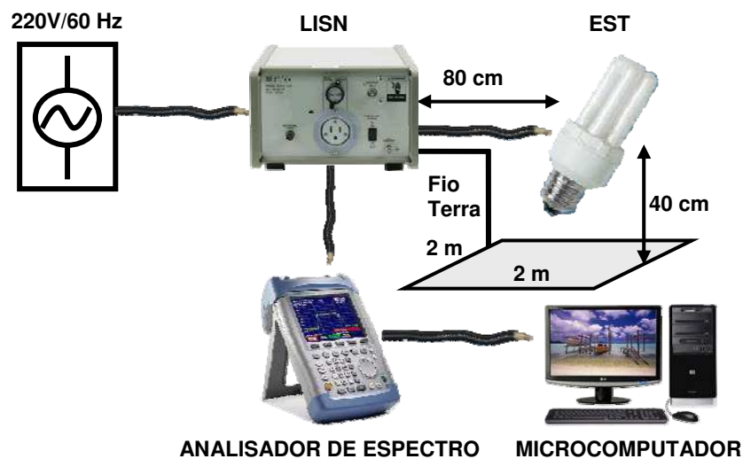
Figura 26 – Montagem para medição da IEM conduzida - norma CISPR 15 (EN 55015).
