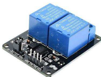
Figura 6 – Módulo Relé 5V – 2 Canais
