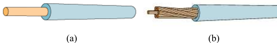
Figura 2 - Condutores isolados: (a) fio e (b) cabo.
