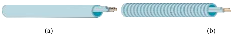
Figura 6 - (a) Eletroduto rígido e (b) corrugado.
