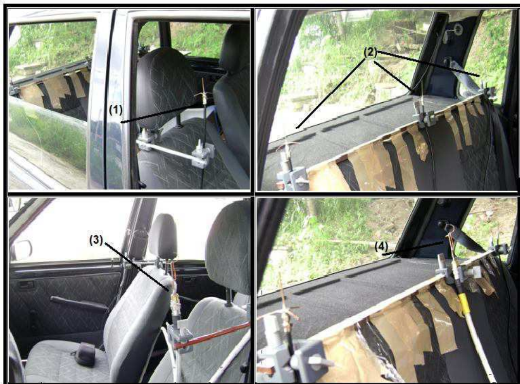
Figura 31- Experimento no interior do automóvel com as antenas dispostas no plano 1 (1,12 m do solo): (1) Antena monopolo no banco dianteiro ocupado pelo passageiro, (2) Antenas monopolo no banco traseiro para os três assentos dos passageiros, (3) Antena dipolo de duplo arco no banco do passageiro e (4) Antena dipolo no banco traseiro em uma das posições dos passageiros.
