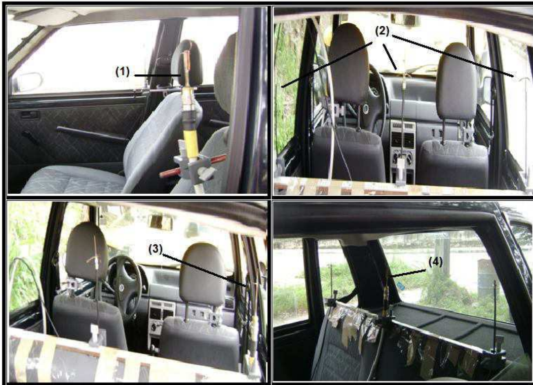
Figura 32- Experimento no interior do automóvel com as antenas dispostas no plano 2 (1,26 m do solo): (1) Antena dipolo de duplo arco no banco do motorista, (2) Antenas monopolo no banco traseiro para os três assentos dos passageiros, (3) Antena dipolo de duplo arco no banco traseiro na posição do monopolo 2 e (4) Antena dipolo no banco traseiro na posição do monopolo 3.
