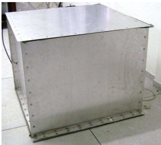
Figura 19- Câmara de reverberação construída no LEMA/DEE/CEEI/UFCG.
