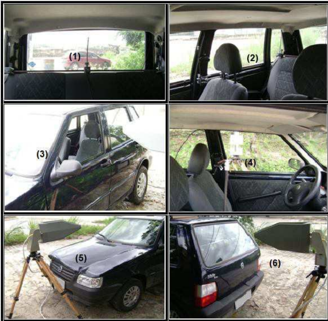
Figura 25 - Experimento ao redor do carro: (1) Três antenas monopolo posicionadas no banco traseiro do automóvel, (2) Uma antena monopolo posicionada no banco do passageiro dianteiro, (3) e (4) Medições do nível de sinal nas laterais do automóvel com a log-periódica, (5) Medição com a log-periódica do nível de sinal próximo ao vidro dianteiro do automóvel e (6) Medição com a log-periódica próxima ao vidro traseiro do automóvel.
