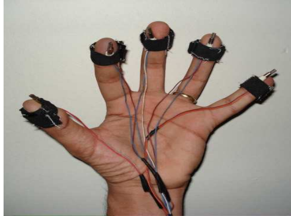
Figura 4 – Transdutores dispostos em forma de luva e presos aos dedos por meio de velcros elásticos.
