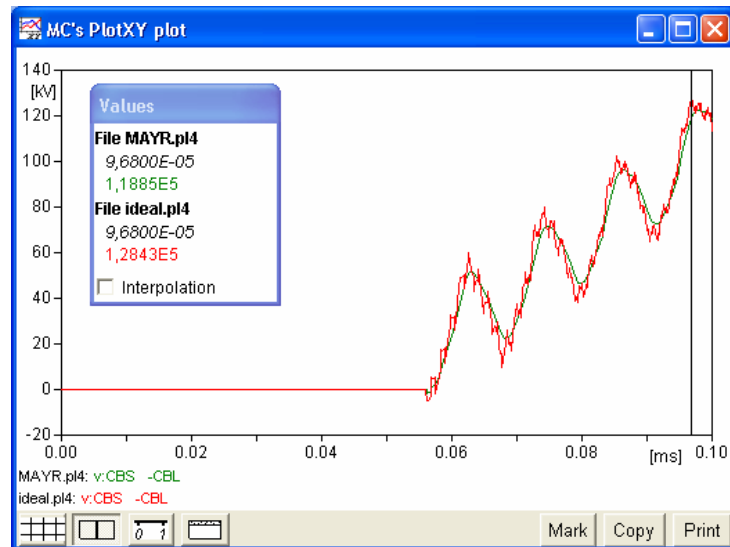
Figura 4.6 TRT no disjuntor com corte de corrente em I = 15 A.
