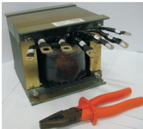
Figura I.7: Indutor de acoplamento utilizado para o filtro ativo paralelo.
