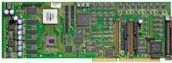
Figura 3.1: Placa controladora dSPACE DS1103 PPC.
