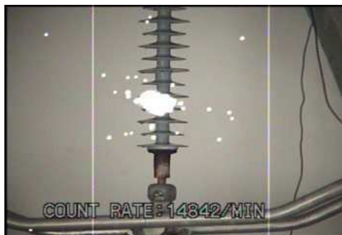
Figura 4.27. Imagem detectada pela câmera UV para isolador envelhecido e poluição nível 2.
