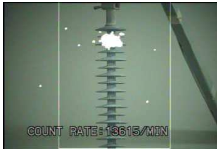
Figura 4.21. Imagem detectada pela câmera UV para isolador envelhecido e poluição nível 1.
