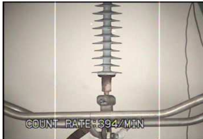
Figura 4.33. Imagem detectada pela câmera UV para isolador envelhecido e poluição nível 3.
