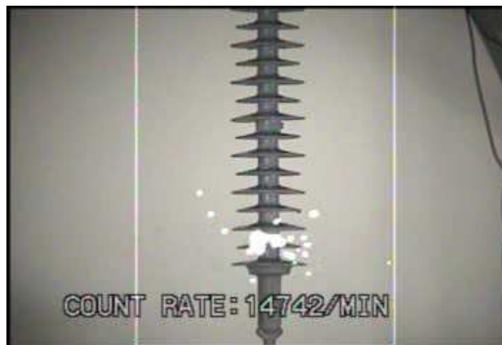
Figura 4.25. Imagem detectada pela câmera UV para isolador sem defeito e poluição nível 2.
