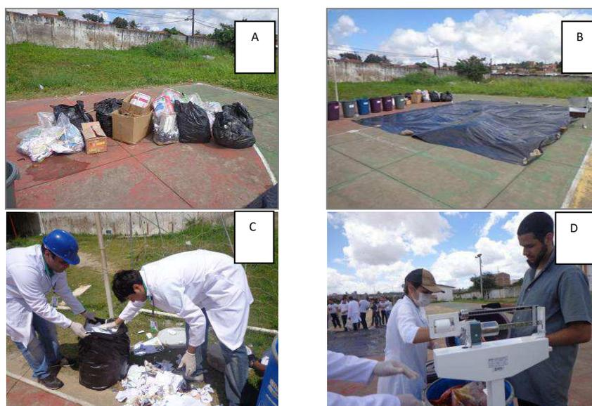
Figura 1. Procedimentos realizados para a composição gravimétrica dos resíduos: (A) Sacos plásticos com de resíduos; (B) Lona para espalhar os resíduos; (C) Separação; (D) Pesagem.
