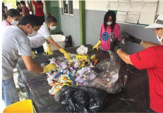
Figura1. Equipe de Alunos e Professores efetuando o levantamento gravimétrico.
