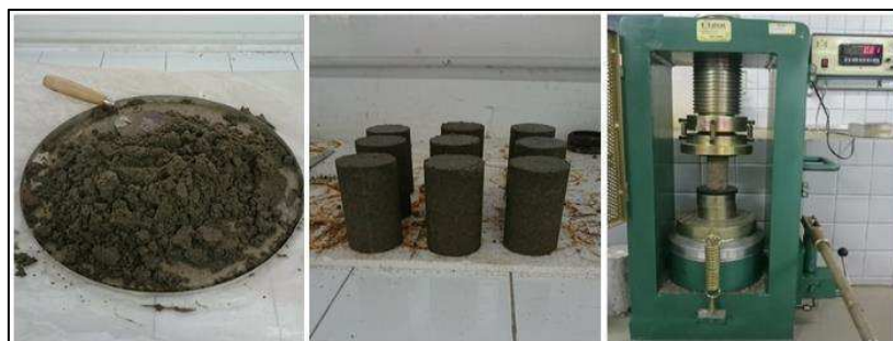
Figura 1. Massa pronta, corpos de prova e ensaio de resistência a compressão simples.
