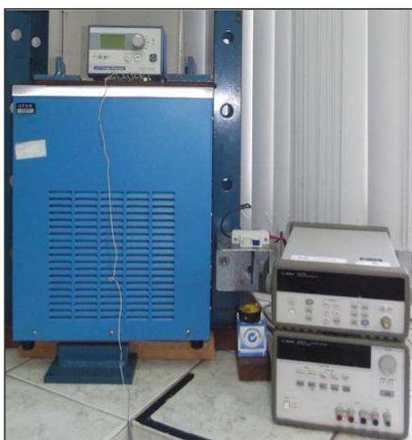
Figura 15. Plataforma experimental de medição da resistência elétrica em função da temperatura em amostras de LMF.
