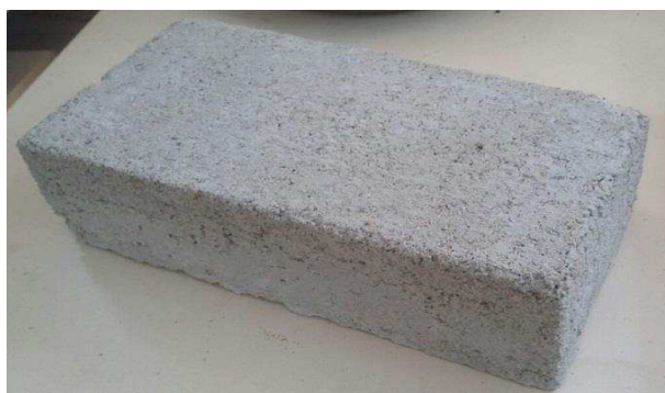
Figura 2. Paver (bloket) ecológico com 7,5% de resíduos de PET inseridos.
