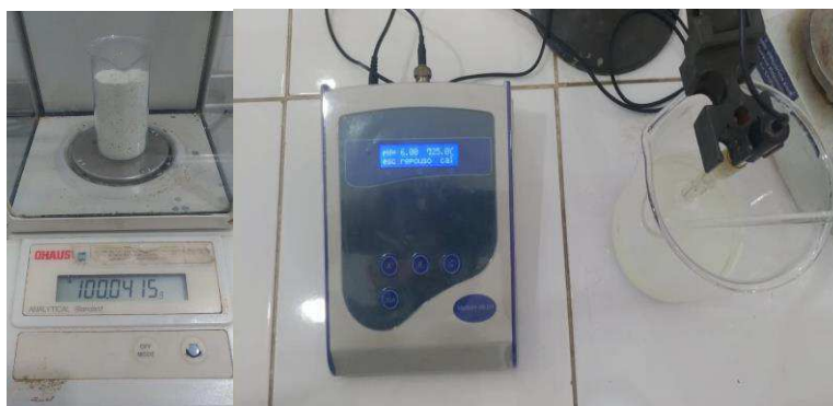
Figura 27 – Nanopartículas de ZnO utilizadas na modificação e medida do pH da água destilada com pHmetro após mistura com as nanopartículas e adição de \text{HNO}_3 .
