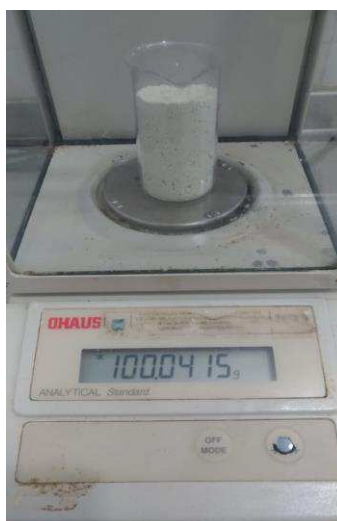
Figura 24 - Nanopartículas obtidas pelo método de Pechini
