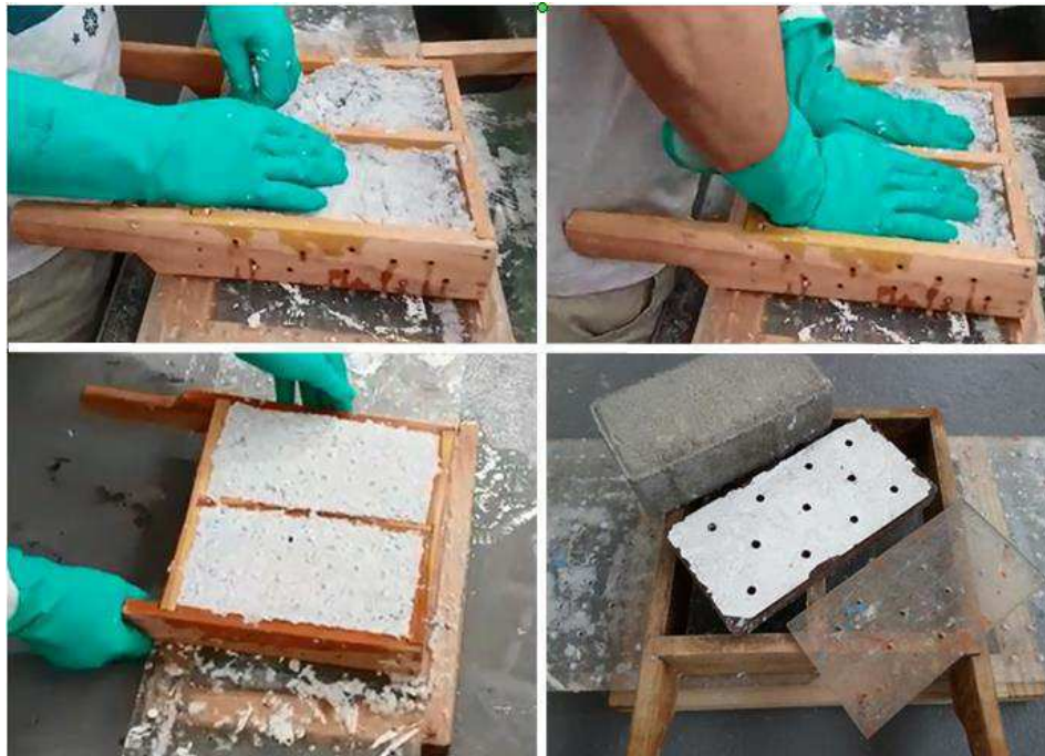
Figura 1. Processo da prensagem da massa na fôrma.
