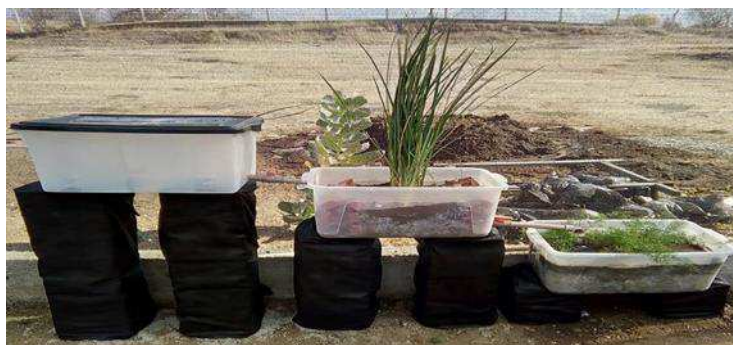
Figura 1. Esquema do Sistema de Alagado Construído (SACs).
