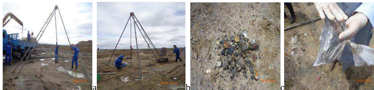
Figura 1. Detalhes da operação para a coleta de resíduos sólidos urbanos na Célula 2; A) Montagem do equipamento de SPT; B) Penetração do cilindro por meio de golpes para a coleta de RSU; C) Amostra de RSU retirada do interior da C2; e D) Acondicionamento da amostra de RSU para a sua devida preservação e condução ao laboratório.
