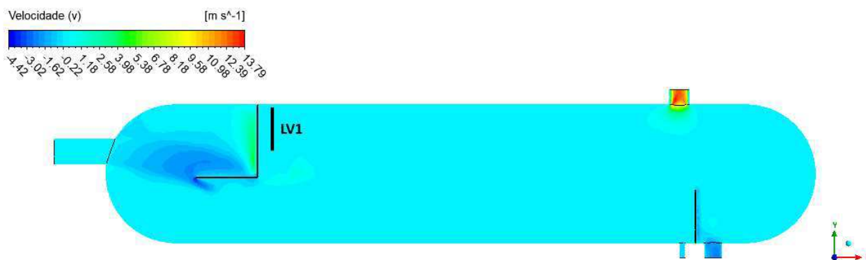
Figura 4.87 - Contornos de velocidade ( v ) na direção y (Caso 10)
