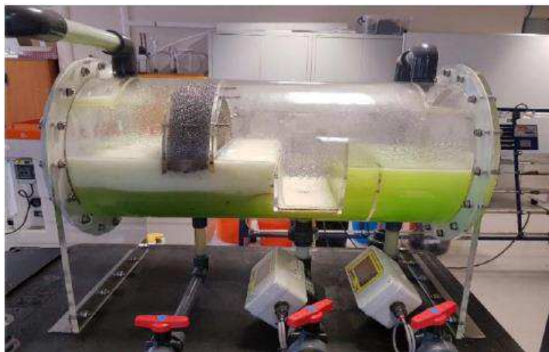
Figura 2.15 - Separador horizontal experimental com bucket e weir
