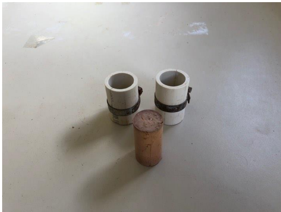
Figura 17 – Moldes para confecção dos corpos de prova para o ensaio de absorção e perda de massa por imersão.
