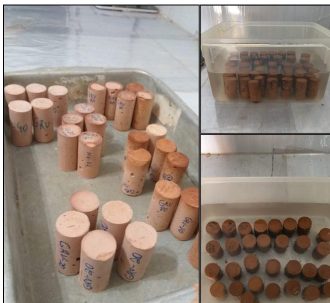
Figura 31 - Amostras antes e depois do ensaio de absorção por imersão.
