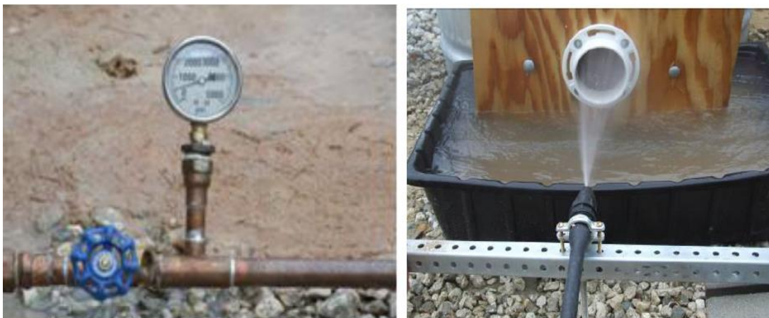
Figura 18 - – Ensaio de erosão em blocos estabilizado (adaptado por Heathcote, (2003)).
