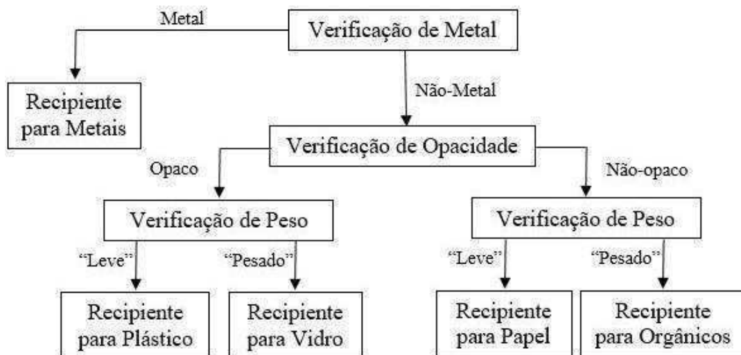
Figura 3. Fluxograma de processos para a separação do lixo.
