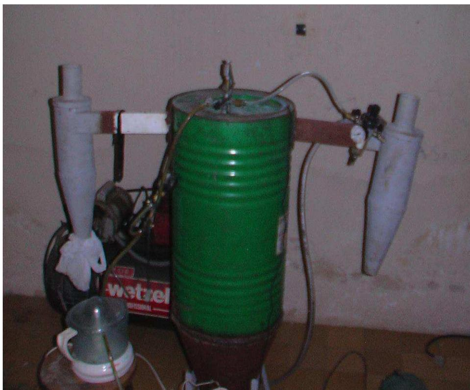
**Figura 2.** Fotografia do equipamento de secagem das suspensões.
