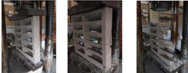
Figura 4. Processo do ensaio de resistência à compressão.
