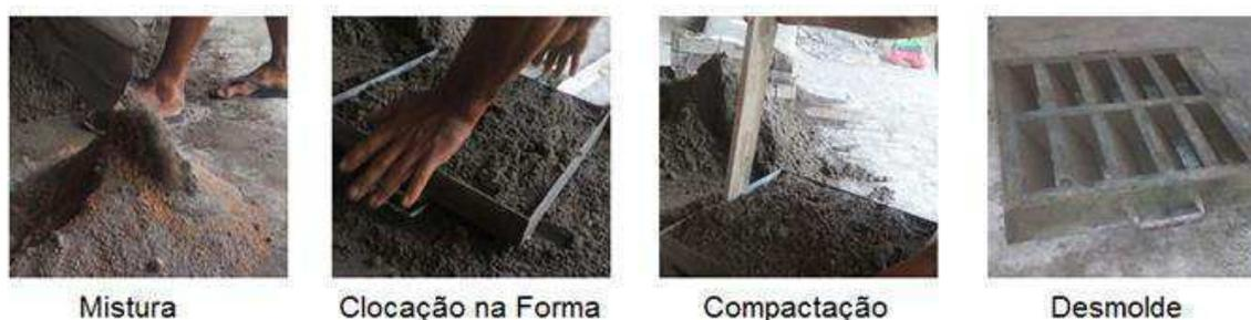
Figura 2. Preparação da argamassa e montagem da peça.
