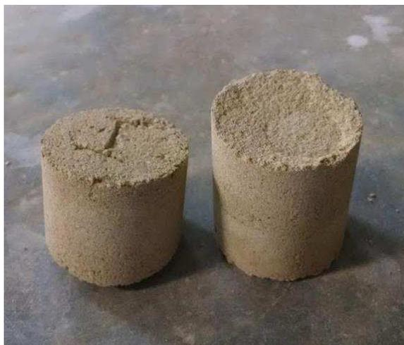
Figura 1. Corpo de prova I quebrado.
