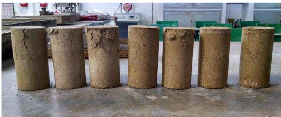
Figura 2. Corpos de prova pós-ruptura em prensa hidráulica.
