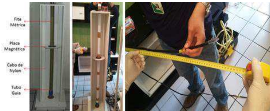
Figura 2. O ensaio para análises dos sistemas de medição.
