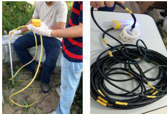
Figura 1. Sistemas de Medições de Recalques em Profundidade.
