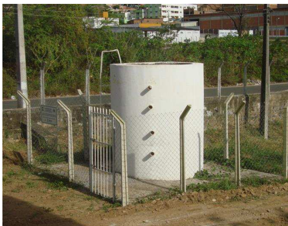
Figura 1. Lisímetro de RSU localizado na UFCG.
