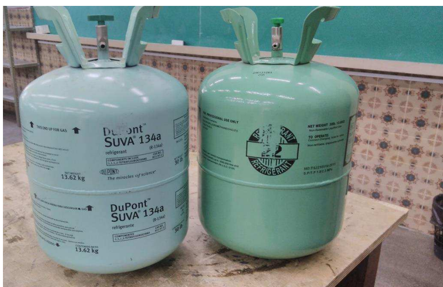
Figura 4. Cilindros descartáveis de gases de refrigeração.
