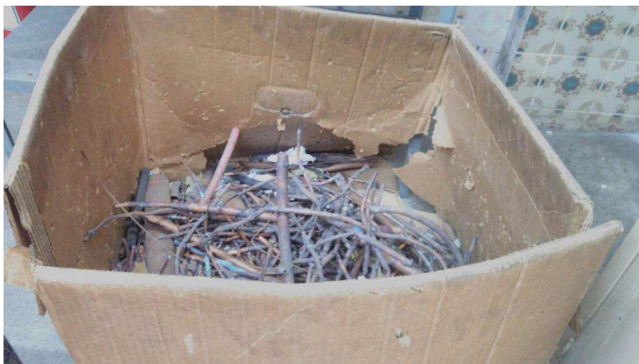
Figura 3. Resíduos de tubos e soldas.
