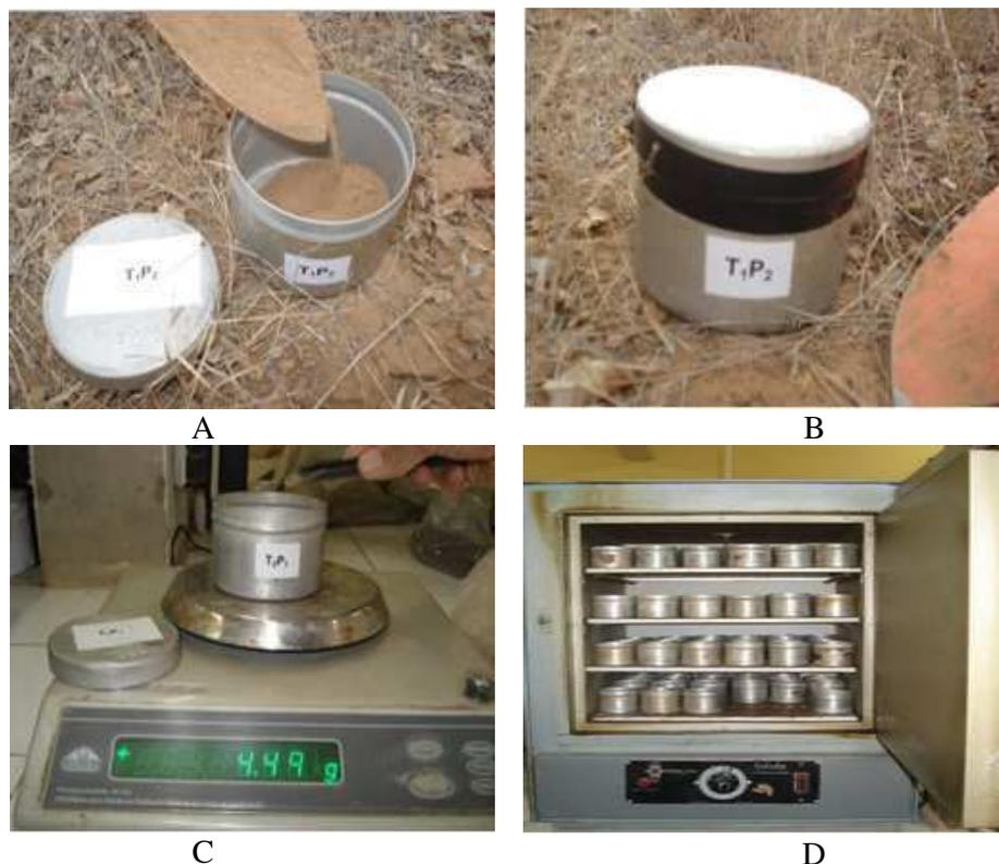
Figura 10. Coleta de amostras de solo na profundidade de 0-10 cm (A), acondicionamento em latas de alumínio (B), pesagem das latas (C) e secagem em estufa a 105 °C durante 24 horas (D).
