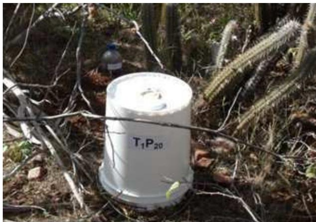
Figura 7. Balde utilizado na medição do CO<sub>2</sub>.
