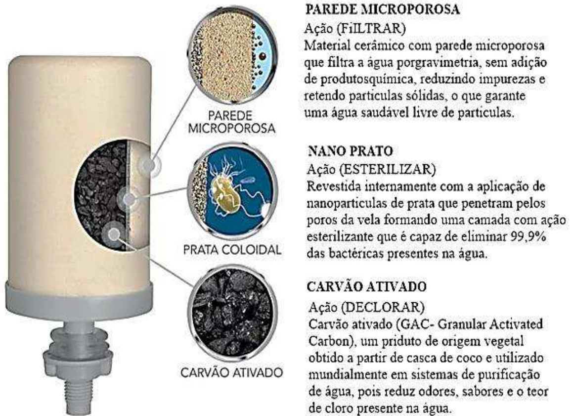
Figura 2: Composição da vela tripla ação.
