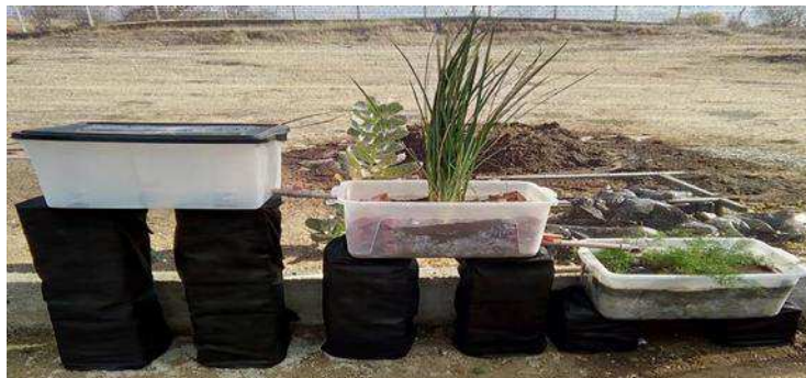
Figura 1. Esquema do Sistema de Alagado Construído (SACs).
