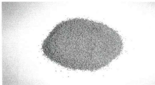
Fig. 2 (a) Argila Chocolate com diâmetro médio de partículas 0,855mm.
