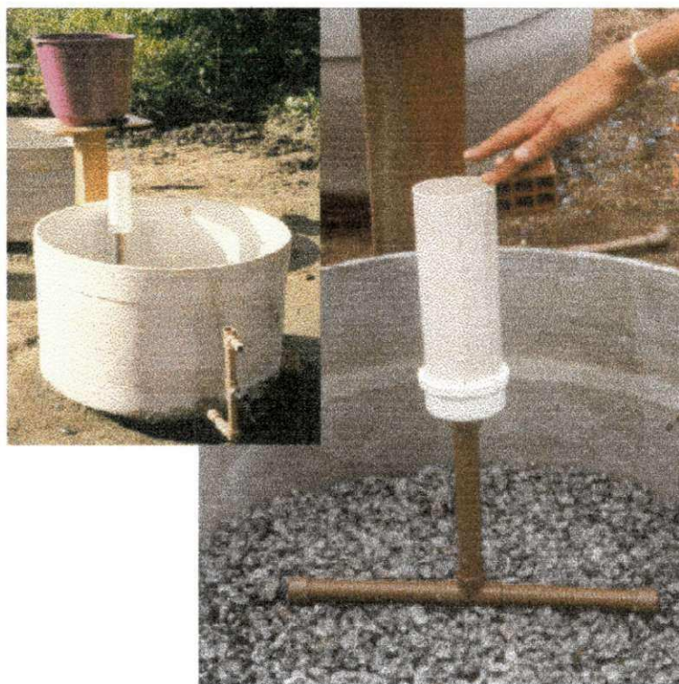
Figura 4.3 – Dispositivo de distribuição de água para os tanques dos sistemas de terras úmidas construídas.
