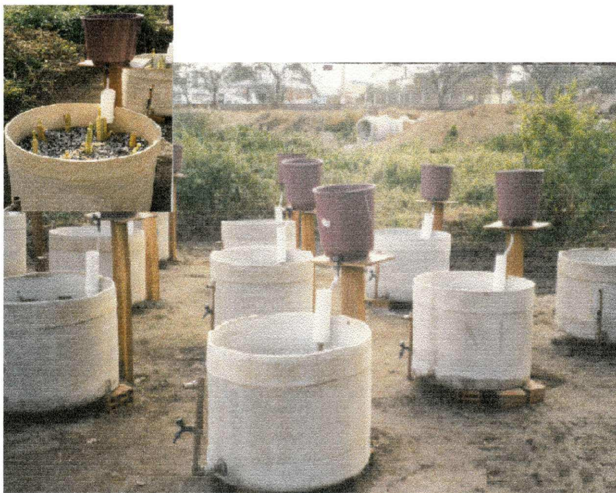
Figura 4.5 – Vista do sistema de terras úmidas construídas I, recém-instalado, com detalhe do tanque.
